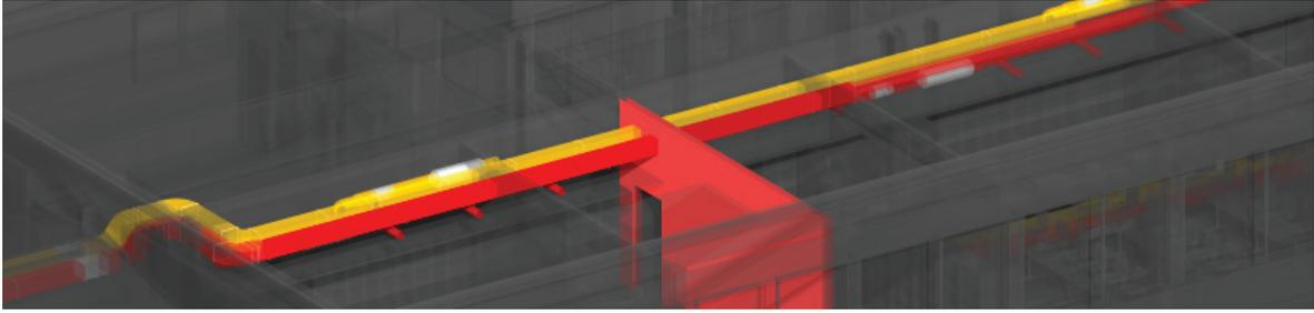
Abbildung 4.31: Kollisionsüberprüfung zwischen Architektur- und Lüftungsmodell (Quelle: OBERMEYER Planen+Beraten)
